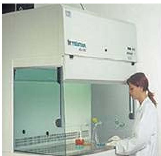
**Figura 4. Flujo laminar para el cultivo de tejidos.** Se observa uno de los modelos de flujo laminar que puede usarse para preservar la esterilidad de las muestras. Imagen tomada de [www.jaelsa.com/laboratorio4.html](http://www.jaelsa.com/laboratorio4.html)
